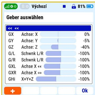
Die Parameter „Achse X «“ und „Achse X »“ repräsentieren virtuelle Schalter mit zwei Zuständen. Diese werden aktiviert, wenn der Sender nach links oder nach rechts entlang der X-Achse geneigt wird.
