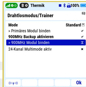
Das 900MHz Backup-System kann zusätzlich zu den bekannten HF Optionen der JETI Duplex Sender genutzt werden. So wird eine maximale Redundanz und Sicherheit durch den Einsatz sehr unterschiedlicher Frequenzbereiche erreicht. In dem Menüpunkt „**Drahtlosmodus/Trainer**“ setzen Sie dazu den Haken bei **900MHz Backup aktivieren setzen**. Das Binden des 900MHz Rsat erfolgt auf die gleiche Weise wie bei den herkömmlichen Duplex 2,4GHz Empfängern.
