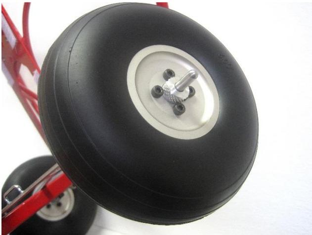
Als nächstes werden die beiden hinteren Räder montiert. Mitteln sie die Achse aus und schieben Sie die Räder auf. Diese werden dann mit den beiliegenden Stellringen gesichert. Achten Sie auf freigängigkeit der Räder.
