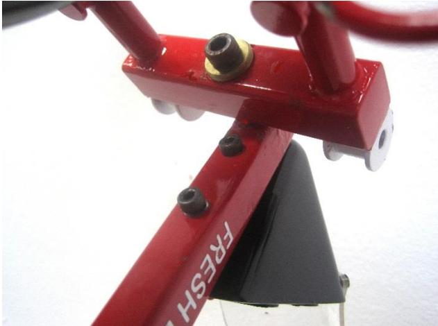
Befestigen Sie zuerst die fordere Gabel mit der Inbusschraube am Rahmen. Danach kann der Instrumentenpilz an seinem Platz montiert werden. *First attach front fork with the allensocket screw. Then the instrument panel can be mounted on his place.*
