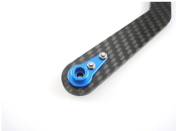
Die Alu-Servohebel werden mit zwei M2x8 Schrauben und Muttern an den Cfk-Arm geschraubt. Sichern Sie die Muttern mit Schrauben-Sicherungslack.
