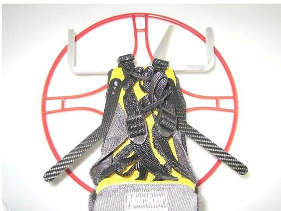
Wird der „Höhenruderknüppel“ nach hinten gezogen, werden beide Arme nach unten bewegt. Der gesamte Schirm wird angebremst. Diese Funktion ist nützlich um das Modell kurz vor der Landung abzufangen oder beim Thermikfliegen durch geringes Anbremsen zusätzlichen Auftrieb zu erzeugen.
