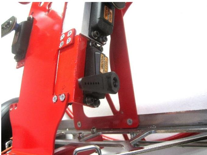
Die Beschleuniger-Servos werden mit den optionalen Servohalterungen am Metallsitz verschraubt. Führen Sie die Beschleuniger Leine vom A-Tragegurt nach unten durch den angeschweißten D-Ring zum Servo. So erhalten Sie eine gerade und optimale Umlenkung.
