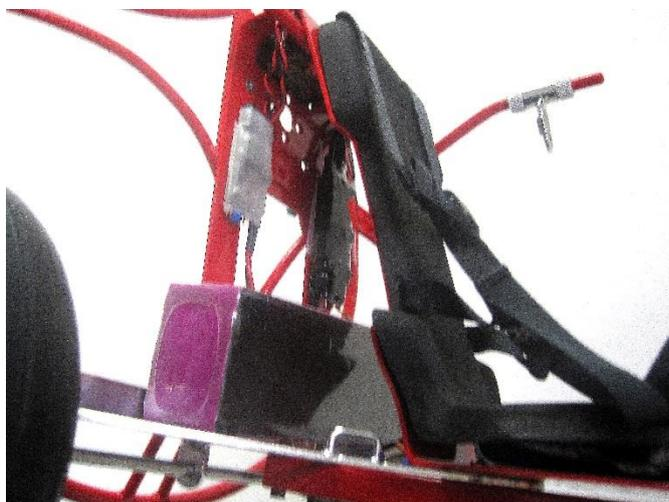
Der Empfänger, das SBEC und Regler werden mit Klettband gesichert. Der Flugakku wird ebenso mit Klettband am Metallsitz fixiert.
