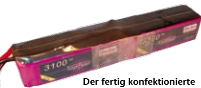
Der fertig konfektionierte 10s LiFe 3.100. Auf zusätzliche mechanische Schutzmaßnahmen wurde verzichtet. Gewicht: 1.042 Gramm
