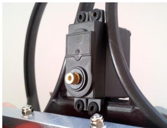
Montieren Sie anschließend die beiden M3x16 Schrauben mit jeweils einer Unterlegscheibe und sichern Sie diese mit jeweils einer M3 Stopmutter samt Beilagscheibe.
