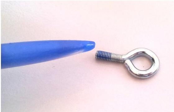
Montieren Sie die beiden Ösenschrauben links und rechts am Alubügel. Verwenden Sie dazu Schraubensicherungslack.
