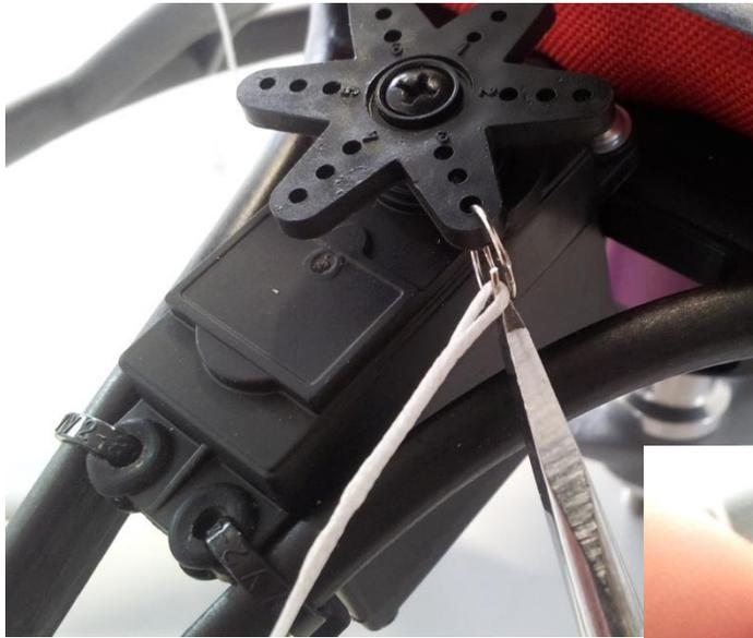
Hängen Sie die beiden Schlaufen an den Schlüsselringen ein. Tipp: Verwenden Sie einen Schlitzschraubendreher und halten Sie mit diesem den Ring geöffnet. So können Sie die Schlaufe ganz einfach einfädeln. Anschließend drehen Sie den Ring bis die Schlaufe komplett eingehängt ist.
