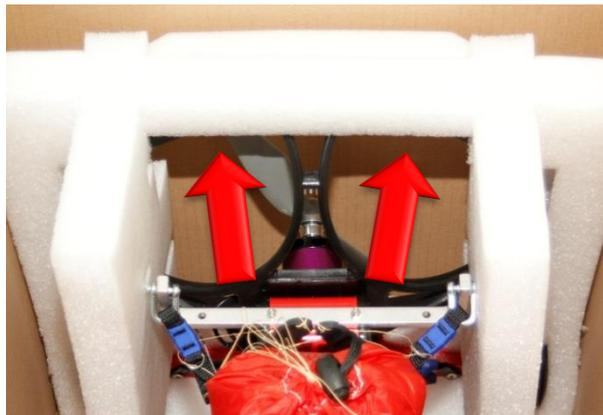
Um Beschädigungen der Leinen und Servos zu vermeiden, empfehlen wir die Motorgondel am Kunststoffkäfig zu greifen und vorsichtig nach oben aus dem Karton zu ziehen. Entfernen Sie anschließend die beiden seitlichen Sicherungsbalken aus Schaumstoff.
