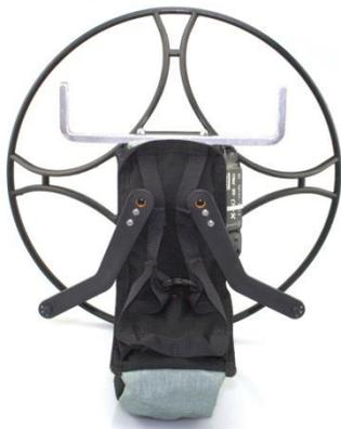
Wird der „Höhenruderknüppel“ nach hinten gezogen, werden beide Arme nach unten bewegt. Der gesamte Schirm wird angebremsst. Diese Funktion ist nützlich um das Modell kurz vor der Landung abzufangen oder beim Thermikfliegen durch geringes Anbremsen zusätzlichen Auftrieb zu erzeugen. Tip: Landen Sie immer mit voll durchgezogenen (angebremssten) Armen um Beschädigungen der Servos zu verhindern.
