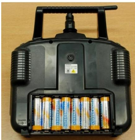
Der Sender wird mit acht vollgeladenen Akkus bzw. neuen Batterien des Typs AA / Mignon (nicht im Lieferumfang enthalten) bestückt, dazu öffnen Sie durch leichten Druck nach innen und unten den Akkufachdeckel.
