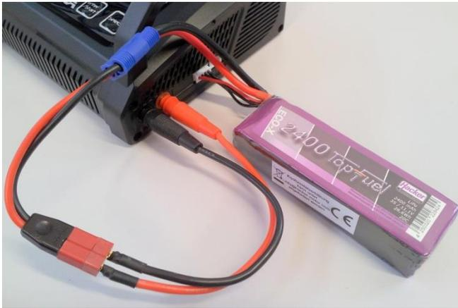
Der Akku kann nun mit dem Ladegerät verbunden werden. Schließen Sie dazu den Balancer-Stecker an die vierpolige Buchse auf der Seite des Ladegeräts an und verbinden Sie Ladekabel und Akkuanschlusskabel.
