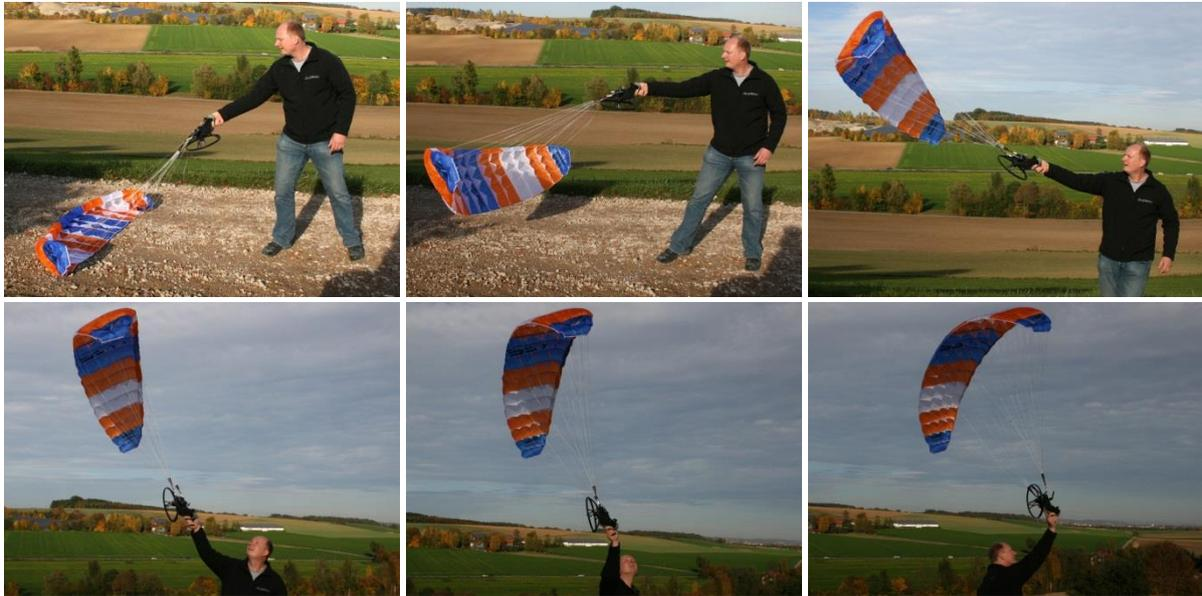
Die Startphase: Den Gleitschirm mit einem Impuls gegen den Wind aufziehen. Halten Sie den Rucksackmotor mittig und laufen Sie vorwärts. Kurz bevor der Schirm am Zenit angekommen ist den Motor anschalten und den Rucksackmotor freigeben. Nicht werfen, sondern leicht nach vorne schieben.
