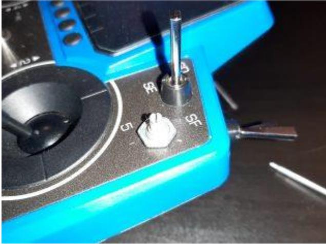
**Schritt 2:** Die Begrenzungscheibe auf den Schalter aufstecken. (Je nach Ausrichtung der Scheibe gibt es zwei Verwendungsvarianten)
