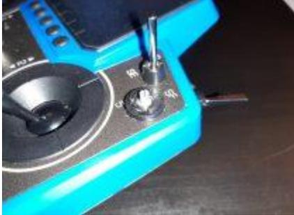
**Schritt 3:** Den Drehgeberherbel aufsetzen und mit einem 1,3mm Innensechskantschlüssel anziehen. (gefühlvoll)
