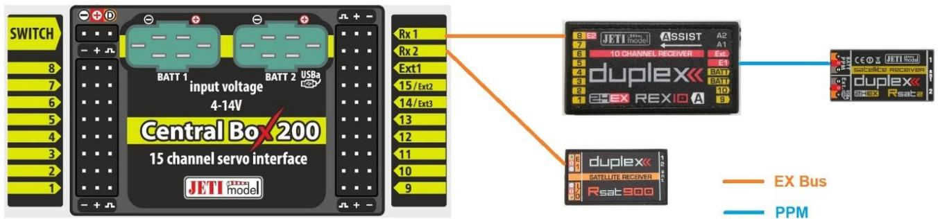
Central Box 100 oder 200 mit Cortex Pro und 2x 2,4Ghz und 900Mhz Empfänger:
