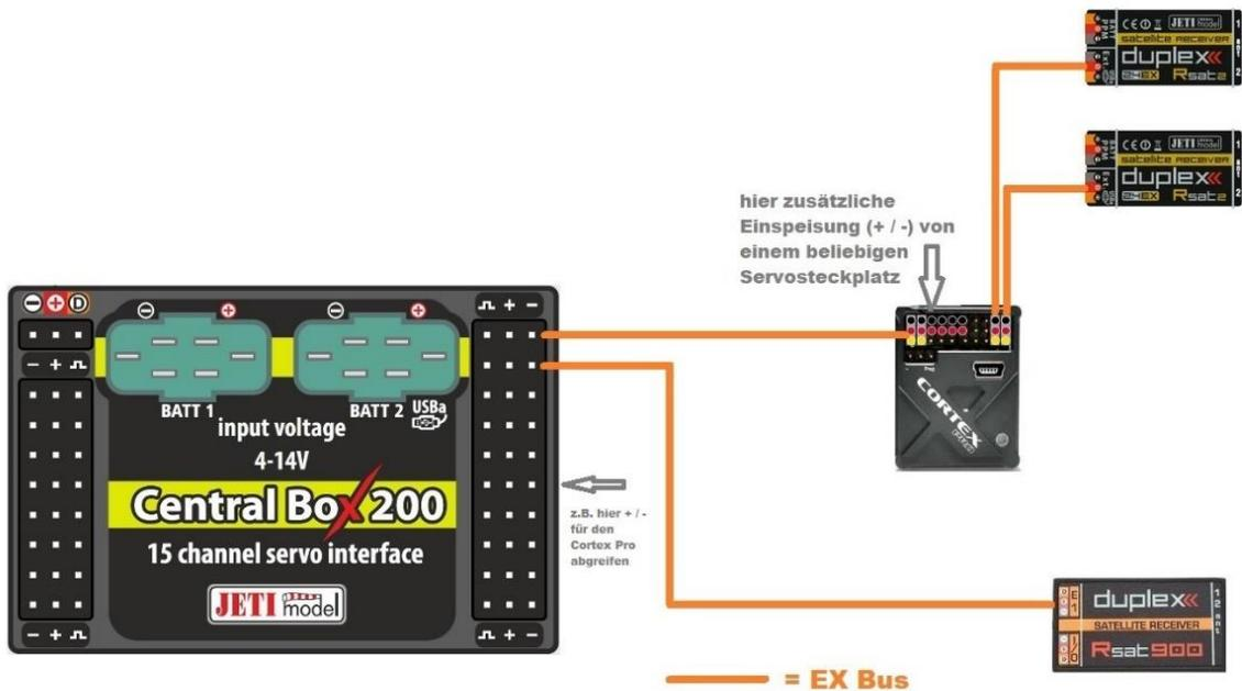
Central Box 400 mit 2x 2,4Ghz Empfänger und 900Mhz Backupempfänger:
