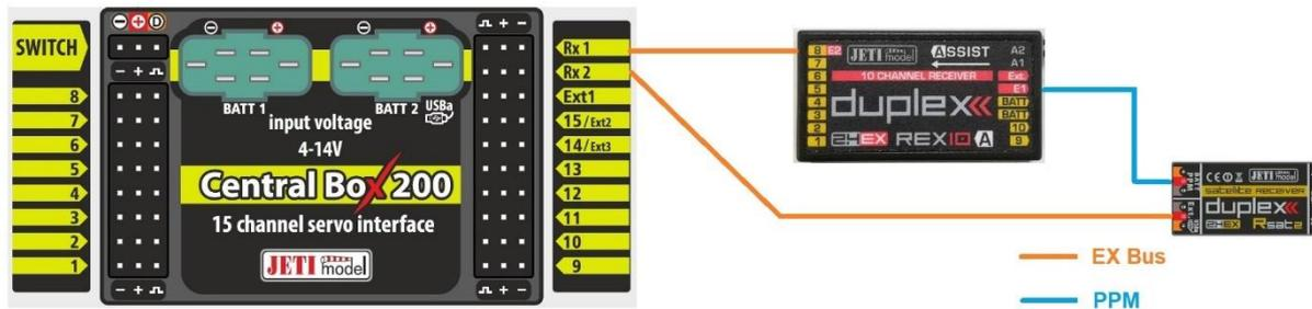
Central Box 100 oder 200 mit zwei 2,4Ghz Empfängern und 900Mhz Backup Empfänger:
