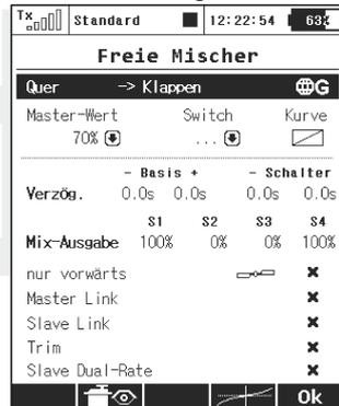
Der oben erwähnte Vorgang hat zum Ziel, bei Bewegung der Querruder gleichzeitig auch beide Klappen auszuschlagen. Damit eine Zumischung der Querruder nur zu den näher am Modellrumpf liegenden Bremsklappen „brake“ erfolgt, ist es erforderlich, in der erweiterten Konfiguration den Parameter „Mix-Ausgabe“ zu ändern und die Spalte **S1** und **S4** auf 0% zu setzen. Infolge dieser Änderung werden die Servos der Klappen **S1** und **S4** nicht weiter vom Mischer beeinflusst.
