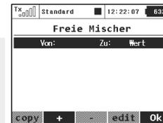
2. Den ersten Parameter „**Von:**“ (=Mischereingang) ergänzen Sie mit der Steuerfunktion „**Elevator**“ (Höhenruder) , den Parameter „**Zu:**“ (=Mischerausgang) ergänzen Sie mit der Steuerfunktion „**Flaps**“ (**Klappen**). „**Master-Wert**“ stellt die Gewichtung dar, in welchem Maße die Höhenruderfunktion die Wölbklappen beeinflussen wird. Mit der Taste „**F5(OK)**“ wird der freie Mischer abgespeichert.
