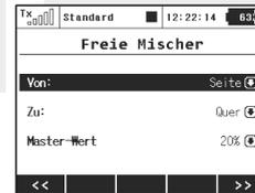
2. Den ersten Parameter „Von:“ (=Mischereingang) ergänzen Sie mit der Steuerfunktion „Rudder“ (Seitenruder), den Parameter „Zu:“ (=Mischerausgang) ergänzen Sie mit der Flugfunktion „Aileron“ (Querruder). „Master-Wert“ stellt die Gewichtung dar, in welchem Maße die Querruderfunktion das Seitenruder beeinflussen wird. Mit der Taste „F5(OK)“ wird der freie Mischer abgespeichert.
