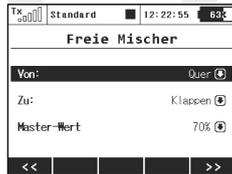
2. Den ersten Parameter „**Von:**“ (=Mischereingang) ergänzen Sie mit der Steuerfunktion „**Ailerons**“ (Querruder), den Parameter „**Zu:**“ (=Mischerausgang) ergänzen Sie mit der Flugfunktion „**Flaps**“ (**Klappen**). „**Master-Wert**“ stellt die Gewichtung dar, in welchem Maße die Querruderfunktion die Wölbklappe beeinflussen wird. Mit der Taste „**F5(OK)**“ wird der freie Mischer abgespeichert.
