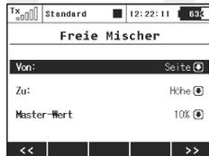
2. Den ersten Parameter „**Von:**“ (=Mischereingang) ergänzen Sie mit der Steuerfunktion „**Seite**“ und den Parameter „**Zu:**“ (=Mischerausgang), ergänzen Sie mit der Funktion „**Elevator**“ (Höhenruder). „**Master-Wert**“ stellt die Gewichtung dar, in welchem Maße die Seitenruderfunktion das Höhenruder beeinflussen wird. Mit der Taste „**F5(OK)**“ wird der freie Mischer abgespeichert.
