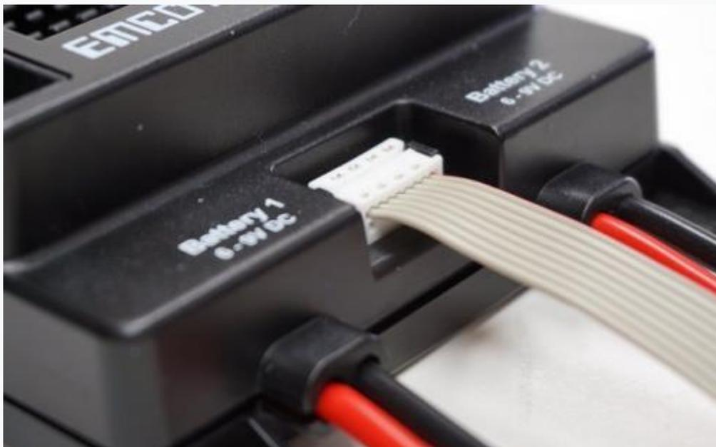
Anschluss DPSI Fernsteuerschaltgeber (Duplex) z. B. an die DPSI 2018 Duplex Edition
