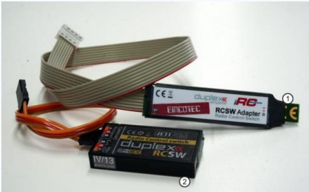
Lieferumfang Variante RCSW Adapter mit RCSW: 1. EMCOTEC RCSW Adapter, 2. Jeti Duplex RCSW RC-Switch
