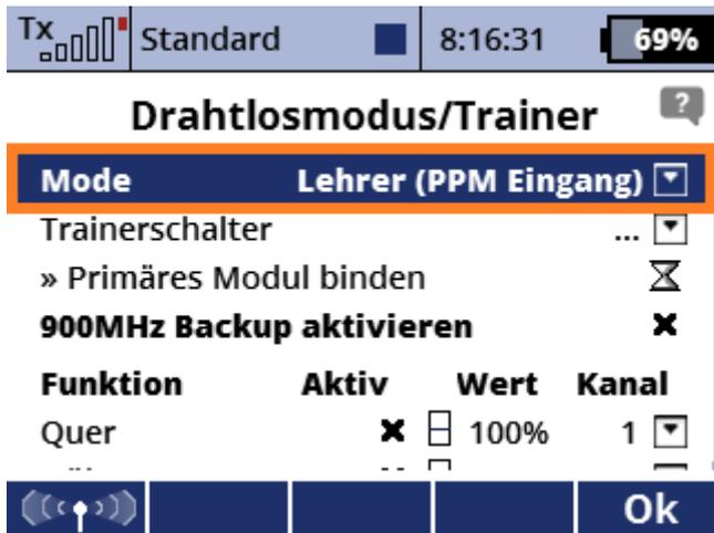
Die Schülerkanäle den Funktionen zuordnen und die Kanäle „ersetzen“. In der Balkenanzeige bei „Wert“ sieht man auch, wenn am Schüler die Knüppel bewegt werden, welcher Funktion welchen Kanal bedient.
