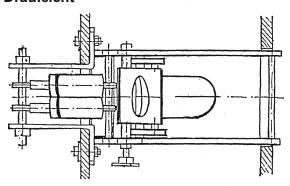
Bei sehr rauhem Flugbetrieb empfehlen wir das Gegenlager für die Dämpfer nach Bild III auszuführen. Diese Befestigungsart entlastet den Befestigungsspant, da die Kräfte direkt in
