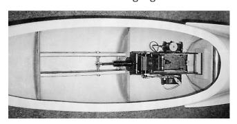
den Rumpf geleitet werden. Die zusätzlichen Längsspanten und der Querspant geben dem Fahrwerk einen optimalen Halt.
