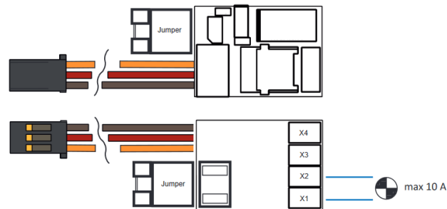
Anschlußschema für Spannungsversorgung über Empfänger
