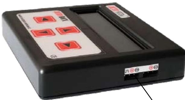
Empfängeranschlußkabel bei BEC-Typen bzw. extra Stecker bei OPTO-Typen hier Polrichtig einstecken
