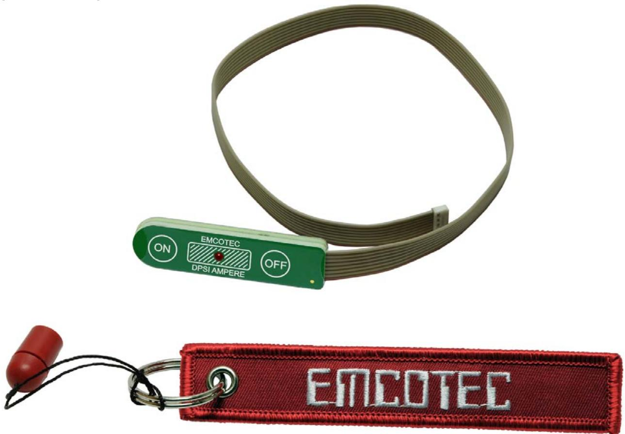
Der Magnetschaltgeber ist für Anwendungen gedacht, bei denen der Rumpf eines Modells nicht durch einen großen Ausschnitt für den Schaltgeber beschädigt werden soll bzw. für Rümpfe, die sehr eng sind (z. B. Seglerrümpfe). Der eigentliche Schaltvorgang erfolgt mit einem externen Magneten, der kurz an die Ein- bzw. Ausschaltposition gehalten wird.
