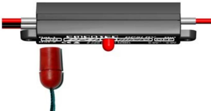
Lorsque le **DPSI Micro - DualBat** est mis en marche alors qu'un des deux accu est défectueux ou manquant, le DPSI entre en mode de programmation. Ce mode s'arrête automatiquement au bout de 30 secondes. Pendant ces 30 secondes, l'accu manquant ne doit pas être connecté, si aucune nouvelle programmation n'est souhaitée.
