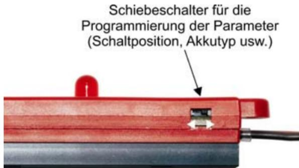
Die Programmierung wird durch unterschiedliche Anzeigen der zentralen LED im **RCS (RV)** begleitet und kontrolliert.
