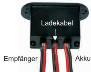
Wenn der Stiftstecker in der schwarzen Buchse steckt, ist das System (Empfänger, Zündung o.ä.) ausgeschaltet; wenn er in der roten Buchse steckt, ist das System eingeschaltet. Als Einschaltkontrolle leuchtet die rote LED. Wenn der Stiftstecker bei eingeschaltetem System aus der roten Buchse entfernt wird, bleibt das System eingeschaltet! Erst das Einstecken in die schwarze Buchse schaltet den Verbraucher aus! Die zulässige Betriebsspannung reicht von 4,8V bis 8,4V.
