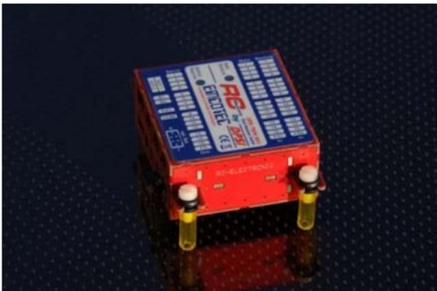
Generell sollte immer auf eine möglichst schwingungsfreie Befestigung geachtet werden. Die Schwingungsdämpfung gilt insbesondere für die Empfänger, da diese weitaus empfindlicher auf mechanische Vibrationen reagieren als das **DPSI TWIN Mini**.
