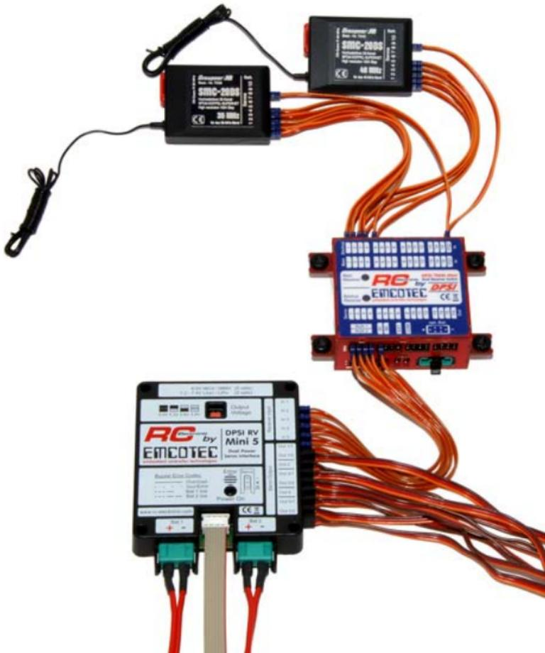
Das **DPSI RV Mini** wird in diesem Beispiel als Servostromverteiler eingesetzt. Das **DPSI TWIN Mini** dient lediglich als Empfängerweiche und wird über die Patchkabel vom **DPSI RV Mini 5** mit Spannung versorgt. Die beiden Empfänger beziehen ihre Spannung aus den Patchkabeln zum **DPSI TWIN Mini**.
