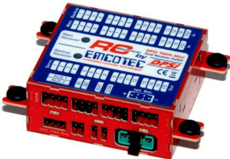
In der oberen Reihe befinden sich die Stiftleisten für die Ausgänge (Anschlüsse zum Servo-Stromverteiler bzw. zu den Servos direkt).
