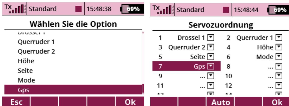
Dann das MGPS mit seiner Datenleitung (schwarzer JR Stecker) an den „Ext.“ Steckplatz des Empfängers (kann beim REX Empfänger auch E1 oder E2 sein, bei passender Programmierung) und den roten JR Stecker auf den gewählten Kanal/Steckplatz des Empfängers (hier im Beispiel 7):
