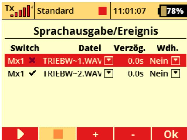
Natürlich kann der Telemetriegeber „MX1“ auch über einen logischen Schalter mit dem Drosselknüppel verknüpft werden. So kann man nur „Gasgeben“ wenn das Triebwerk tatsächlich ausgefahren ist.
