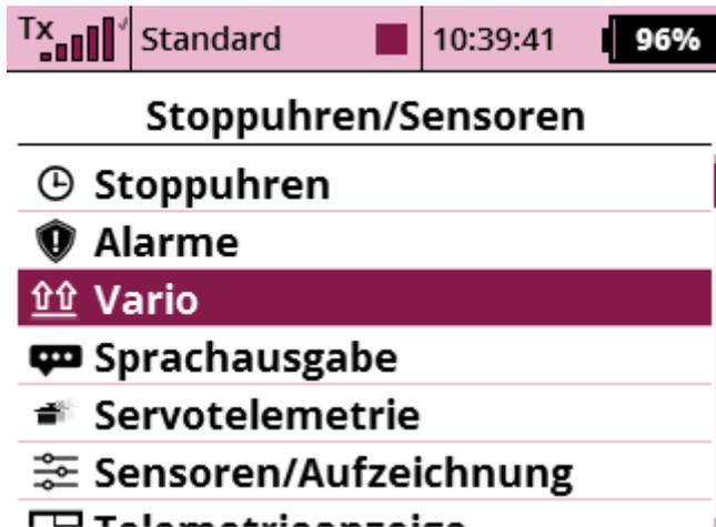
Hier das Vario auf „aktiv“ setzen, evtl. einen Schalter (Switch) zum EIN/AUS schalten des Variotones auswählen, der „Parameter EX“ muß „Vario [m/s]“ sein.
