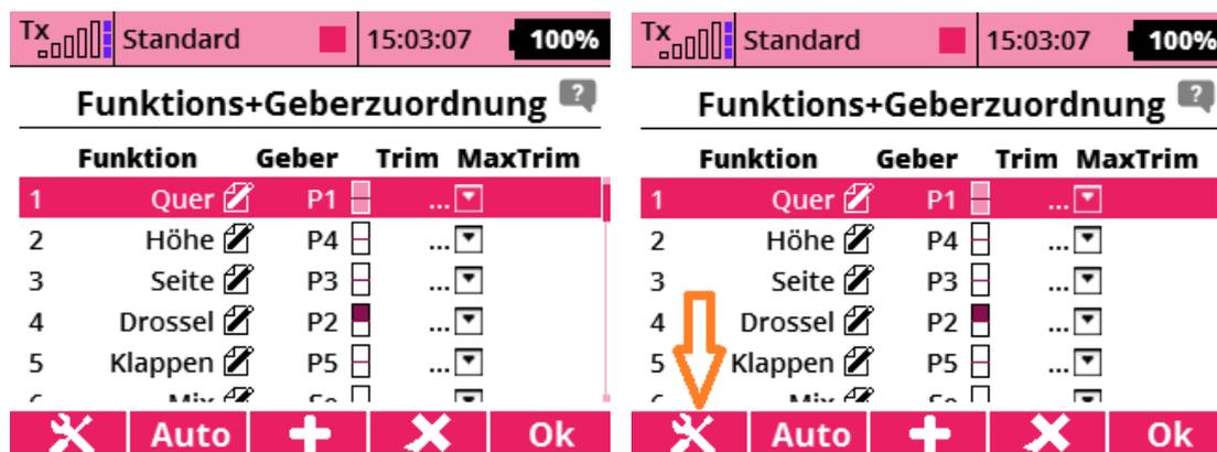
Dann wird die Geberzuordnung zu den Funktionen im Klartext angezeigt. Hier im Beispiel wird die Funktion **Drossel** mit dem **Knüppel P2** bedient. Ich möchte aber auf den **Knüppel P4** wechseln. Also diesen Geber mit dem 3D Auswahlrاد anklicken und den gewünschten Geber im folgenden Auswahlfenster wählen:
