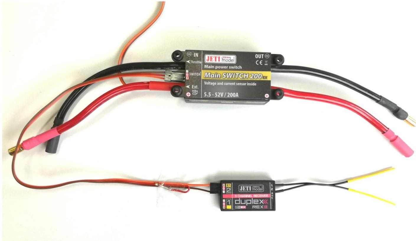
**Die rote Ader des Patchkabels wird entfernt!**
