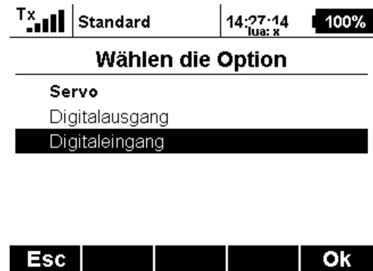
Die Erstellung und Zuordnung des EIN/AUS-Tasters zum Drosselkanal: Steckplatz 11 zeigt „Digital Eingang“
