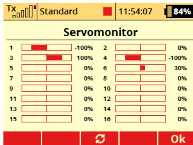
Kontrolle bei Stellung „Klappen = voll gefahren“ und Schieber „P6“ auf negativ 30%:
