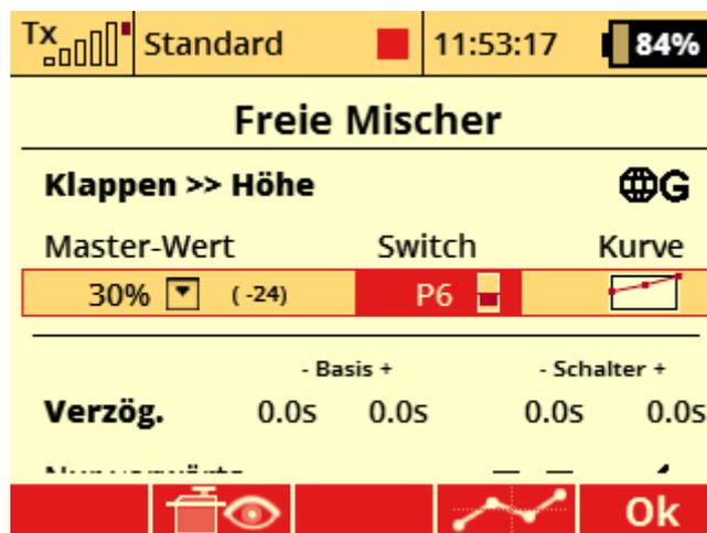
In der Geberauswahl für den P6 die beiden Felder „Mitte“ und „Prop“ mit den Tasten F1 und F2 (unter dem Display) auswählen, so sieht das dann aus:
