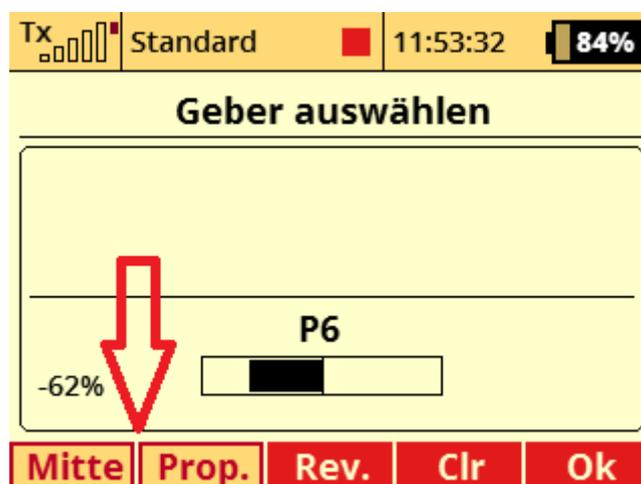
Da die Beimischung nur bei betätigten Klappen erfolgen soll, muss bei Geber in Stellung „Klappen = Null“ die Mischerkurve auch auf Null-Beimischung gestellt werden:
