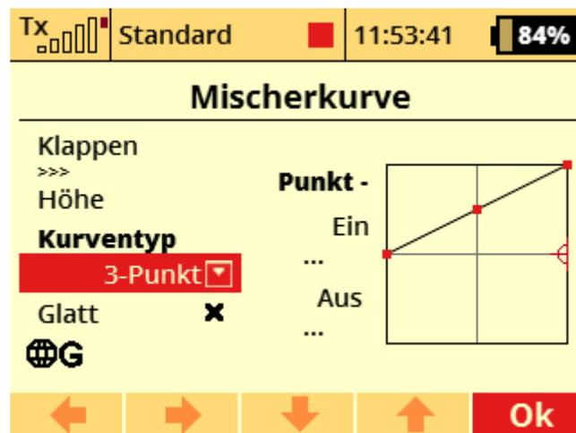
Kontrolle bei Stellung „Klappen = Null“, also keine Höhenruderbeimischung (Kanal 6 ist hier das Höhenruder, Kanal 3 und 4 sind die Klappen):
