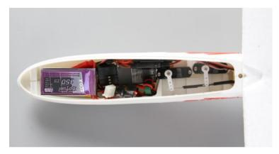
Positionieren Sie den Empfängerakku wie auf dem Bild gezeigt.
