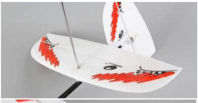
Schrauben Sie da Höhenleitwerk mit der beiliegenden Kunstoffschraube am Rumpf fest. Danach schieben Sie das Gestänge in den Stellring und ziehen Sie die Schraube zur Fixierung des Drahtes am Ruder an.
