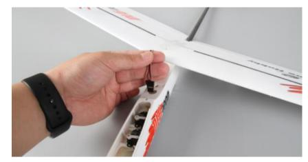
Schieben Sie die Servokabel der Fläche durch die Öffnung im Rumpf nach vorne Richtung Kabinenhaube. Danach schrauben Sie die Fläche mit den beiden Kunststoffschrauben fest.
