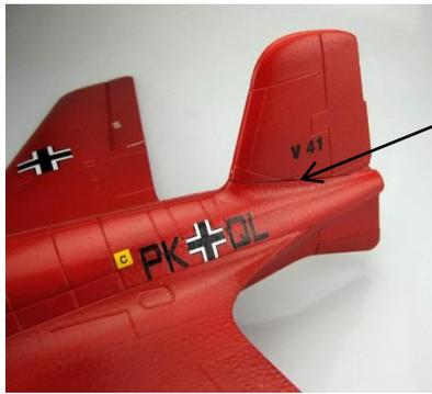
Eingeklebte Seitenflosse / *Glued Rudder*
