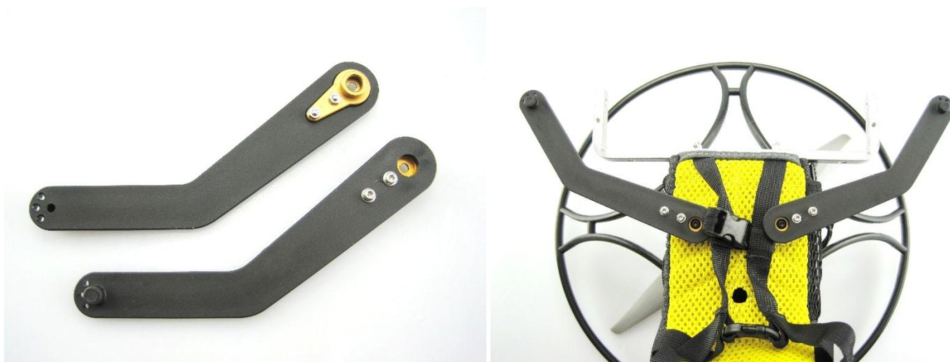
Montieren Sie nun die beiden Servoarme auf die Aluhebel. Diese Einheit wird nun auf die beiden Servos aufgeschraubt.
