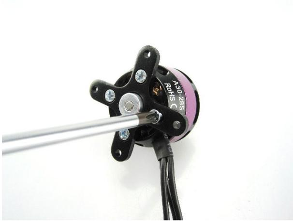
Montieren Sie den Hacker Brushless-Motor mit vier M3x6mm Senkkopfschrauben an das Montagekreuz. Ziehen Sie die Schrauben handfest an, sodass Sie sich während des Fluges nicht lösen können.
