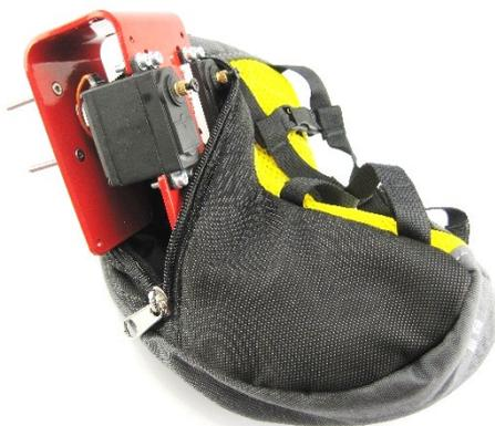
Führen Sie den Metallsitz mit dem unteren Bereich in das Gurtzeug. Metallsitz mit dem unteren Bereich zuerst in das Gurtzeug schieben.
