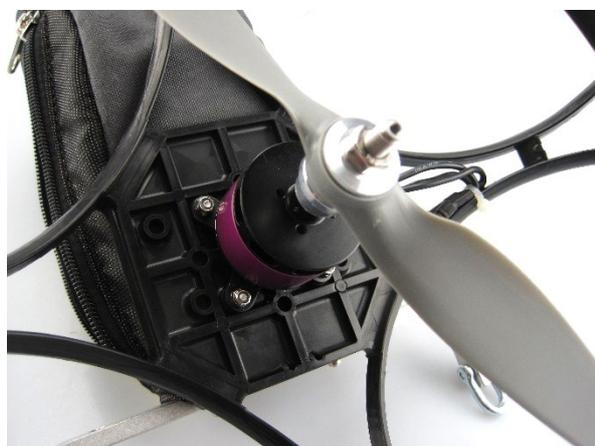
Verwenden Sie eine APC Luftschraube 10x5 und drücken Sie den passenden Zentrierung in die Propellernabe, damit die Luftschraube mittig sitzt. (Die Kunststoffzentrieringe liegen der Luftschraube in unterschiedlichen Größen für unterschiedliche Wellendurchmesser bei). Stecken Sie die Luftschraube mit in Flugrichtung zeigender Beschriftung auf den Mitnehmer. Anschließend montieren Sie die Unterlegscheibe und die Mutter. Ziehen Sie die Mutter gut fest, sodass sich diese im Flug nicht lösen kann.
