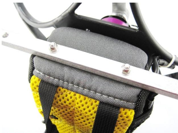
Auf der Oberseite des Metallsitzes sind zwei Bohrungen durch welche zwei M3x16mm Senkkopfschrauben von innen nach außen gesteckt werden. Der Alubügel ist an diesen Schrauben zu befestigen. Halten Sie mit einem langen Inbusschraubendreher die freie Schraube von innen, stecken Sie den Alubügel auf die Schraube und sichern Sie den Bügel mit einer M3 Unterlegscheibe und einer M3 Stopmutter.
