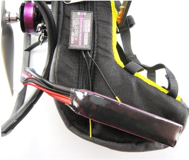
Für den empfohlenen Antrieb benötigen Sie einen 3S LiPo-Akku mit einer Kapazität von bis zu 2500 mAh.
