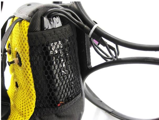
Der Regler wird nun mit den drei Motorkabeln verbunden und in das seitliche Fach gesteckt. Die Kabel fixieren sie am Käfig mit dem beiliegenden Kabelbinder.
