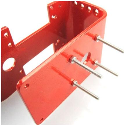
Führen Sie die vier Senkkopfschrauben M3x20mm von innen durch die Rückseite des Metallsitzes. Drehen Sie vier Muttern M3 auf die Schrauben und ziehen Sie diese fest. Es ist hilfreich, wenn Sie beim Festziehen die Schraube von innen mit einem Inbusschraubendreher halten. Die M3x30mm Schraube sollte sich nach dem Festziehen nicht verdrehen lassen.
