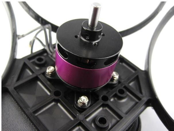
Setzen Sie nun den Hacker Brushless-Motor inklusive montiertem Kreuz auf die M3x20mm Schrauben. Montieren Sie nun die vier selbstsichernde Muttern M3 auf die Schrauben. Nach dem Festziehen sollten Gurtzeug, Metallsitz, Motor und Propellerkäfig eine feste Einheit sein.
