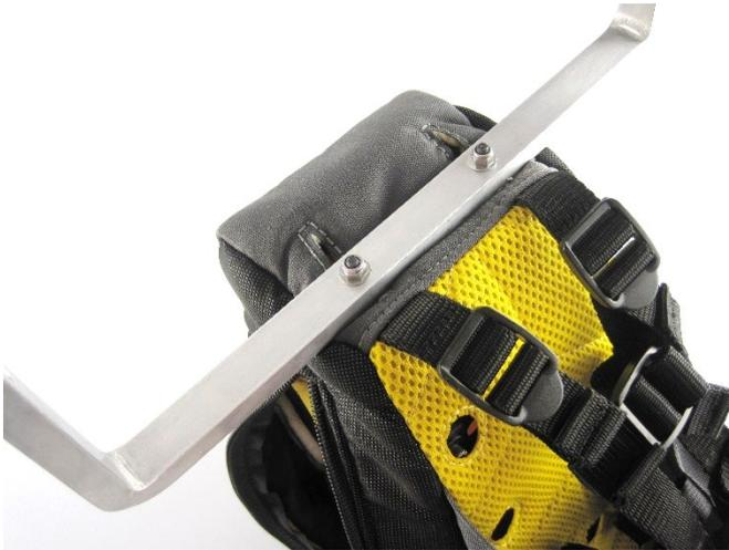
Als nächstes folgt die Montage des Bügels. Schrauben Sie diesen mit zwei M4x20 Inbusschrauben und Stopmuttern fest. Als Grundeinstellung nutzen Sie die zweiten Löcher von vorne am Metallsitz.
