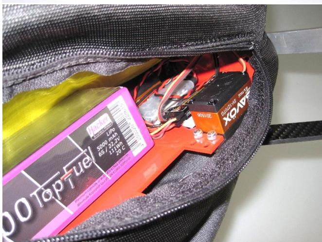
Der Empfänger und das SBEC werden mit Klettband zwischen den beiden Servos gesichert. Der Flugakku wird ebenso mit Klettband am Metallsitz fixiert.
