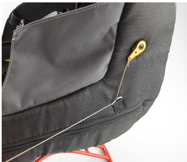
Führen Sie nun das Seil durch den zweiten D-Ring zum Beschleuniger-Servo. Nun knoten Sie das Seil am Servohorn fest. Achten Sie darauf das bei Beschleuniger "Aus" Der Tragegurt der A-Leinen gestreckt ist. Wenn Sie nun den Beschleuniger betätigen sollten beide A-Gurte gleichmäßig nach unten gezogen werden.
