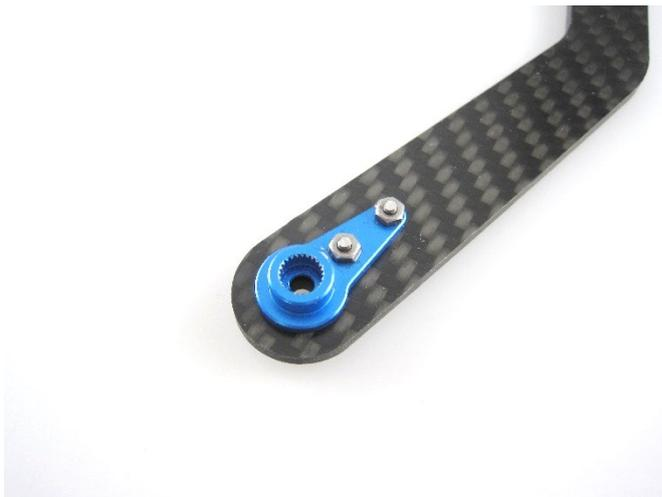
Die Servohebel werden mit zwei M2x8 Schrauben und Muttern an den Cfk-Arm geschraubt. Sichern Sie die Muttern mit Schrauben-Sicherungslack.
