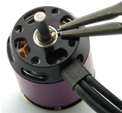
Zunächst muss die alte Motorwelle aus der Glocke entfernt werden. Demontieren Sie dazu zuerst die Glocke. Entfernen Sie den Sicherungsring von der Welle. Verwenden Sie eine Sicherungsringzange, weiten den Ring damit leicht auf und ziehen ihn nach oben.
