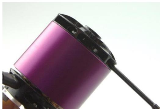
Lösen Sie die beiden Gewindestifte (beim A30 V3 nur ein Gewindestift) mit einem 1,5 mm Inbusschlüssel. Verwenden Sie hochwertiges Werkzeug, um ein Überdrehen des Innensechskants zu vermeiden. Tipp: Erhitzen Sie die Glocke im Bereich der Schrauben vorsichtig mit einem Heißluftföhn oder die Gewindestifte mit einem Lötkolben, sodass sich der Schraubensicherungslack löst. Achtung: Zu starkes Erhitzen kann die Magnete beschädigen.
