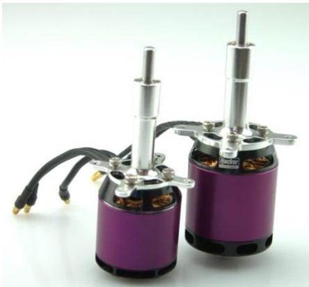
Nun kann der Adapter auf die Welle geschoben und mit den vier beiliegenden Schrauben fixiert werden. Ziehen Sie die Schrauben erst fest, wenn Sie alle einschraubt haben. Das Kugellager des Adapters muss dabei mit den Kugellagern des Motors exakt fluchten.
