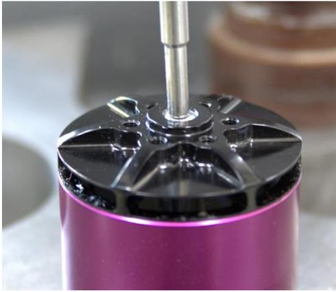
Die Welle kann nun mit einem Durchschlag und einer Presse vorsichtig entfernt werden. Alternativ zu einer Presse kann auch eine Ständerbohrmaschine verwendet werden.
