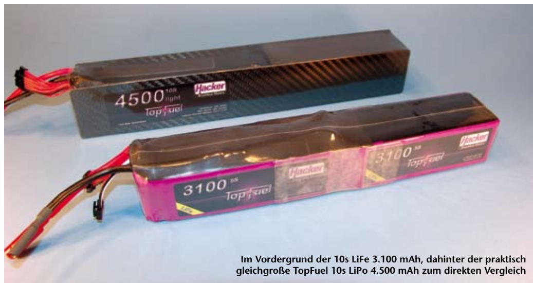
Der fertig konfektionierte 10s LiFe 3.100. Auf zusätzliche mechanische Schutzmaßnahmen wurde verzichtet. Gewicht: 1.042 Gramm
