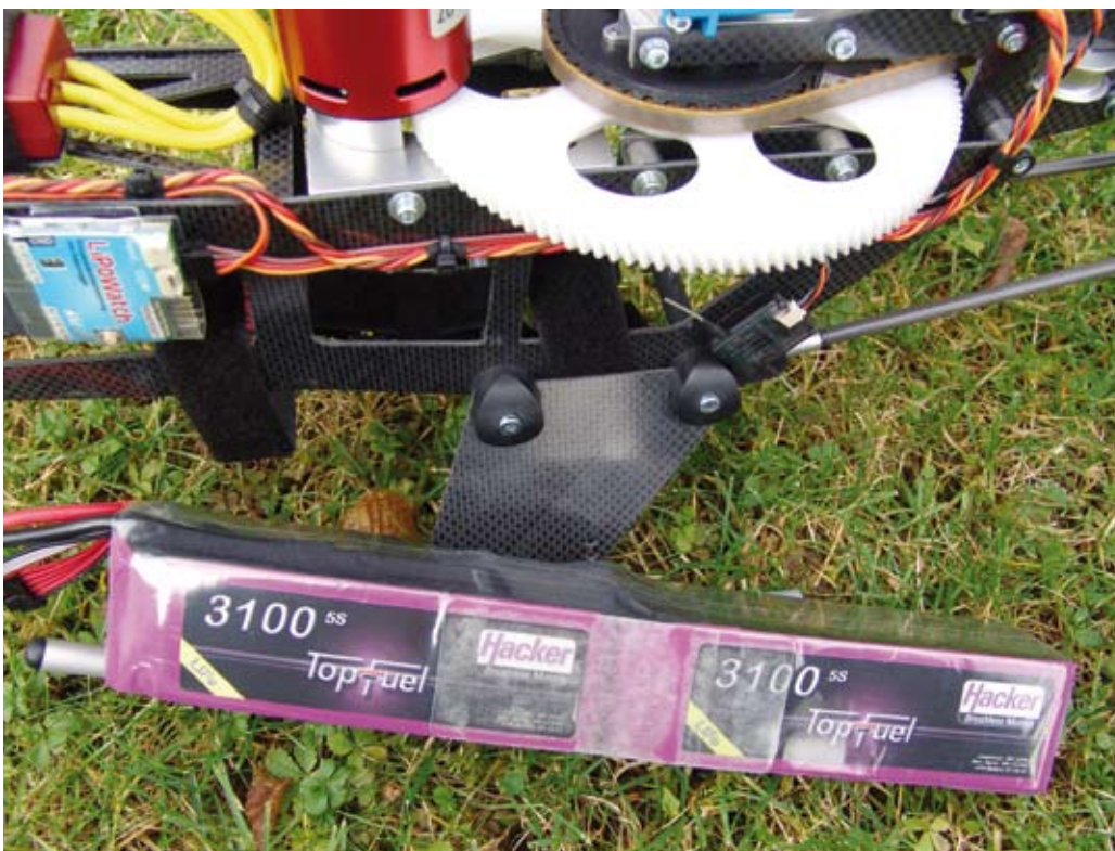
Hacker's LiFes sind in ihren Abmessungen den TopFuel LiPo sehr ähnlich und passen daher ohne Umbauarbeiten in den Akkuschaft
