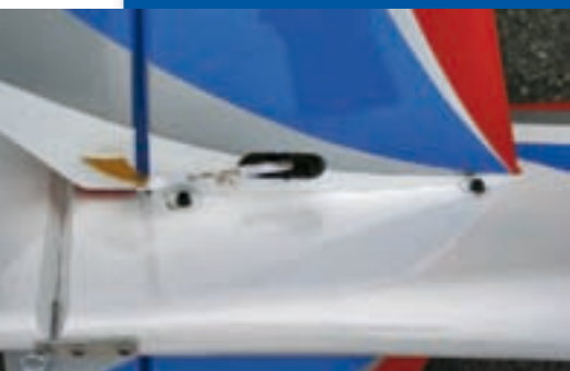
Die Höhenruderservos werden in die Leitwerkshälften eingebaut.
