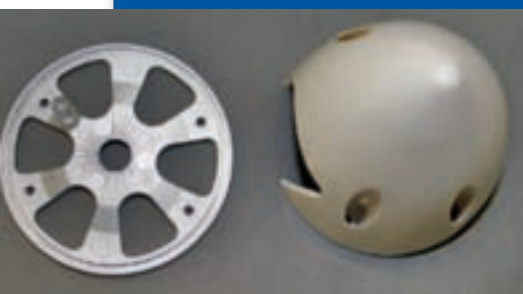
Der beiliegende Spinner ist gewichtsoptimiert und fein gewuchtet, der Ausschnitt für die Luftschaube sind leider viel zu groß.
