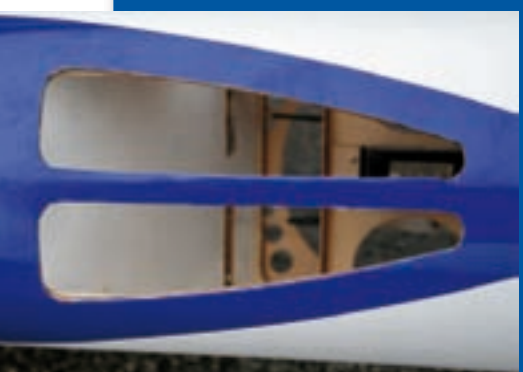
Die Kühlluft wird durch den Rumpf geführt und unten ausgeleitet. Auch hier sind die Öffnungen fertig angebracht und auch die Folie ist bereits entfernt.
