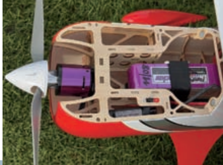
Motormontage und Akkuwechsel erfolgen über die geteilte Motorhaube.
