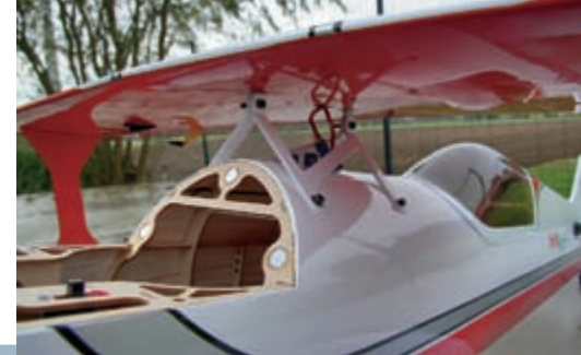
Der Baldachin liegt montagefertig bei und wird lediglich verschraubt.
