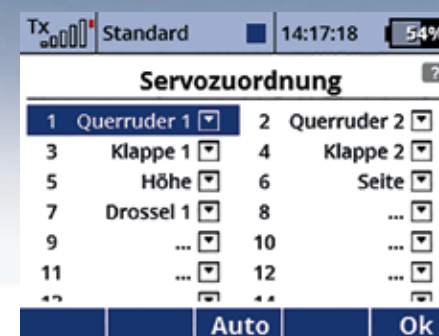
Hier die Servozuordnung im Ausgangszustand ohne Converter
