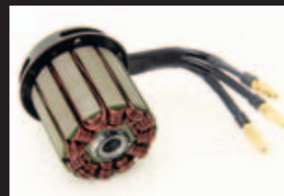
Markant am Turnado Edition 530: Die Wicklung besteht aus 1,5 Millimeter starkem Volldraht, um den Innenwiderstand zu reduzieren. Zudem kommen hochwertige EZO-Markenkugellager zum Einsatz
