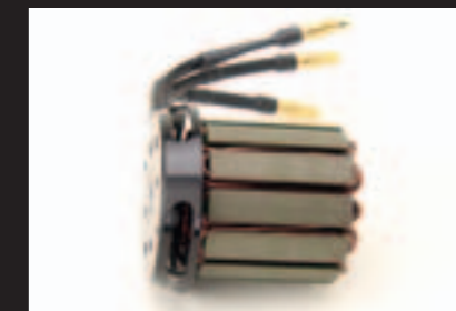
Markant am Turnado Edition 530: Die Wicklung besteht aus 1,5 Millimeter starkem Volldraht, um den Innenwiderstand zu reduzieren. Zudem kommen hochwertige EZO-Markenkugellager zum Einsatz
