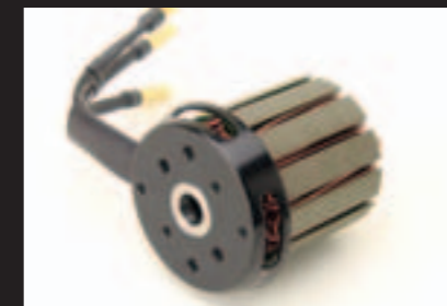
Markant am Turnado Edition 530: Die Wicklung besteht aus 1,5 Millimeter starkem Volldraht, um den Innenwiderstand zu reduzieren. Zudem kommen hochwertige EZO-Markenkugellager zum Einsatz
