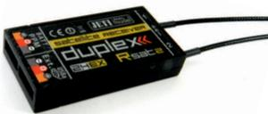
Der zusätzliche Satellitenempfänger RSat2 dient zur Ergänzung der Empfänger **R9**, **R11EPC**, **R14** und **R18**. Es handelt sich um einen vollwertigen Empfänger des Systems DUPLEX mit allen Funktionen, die dieses System bietet. Der Ausgang des Empfängers RSat2 liefert keine klassischen Servoimpulse, sondern ein PPM, UDI, EX BUS Signal, über welche die Kommunikation zu den oben angeführten Empfängern und Central Boxen erfolgt.
