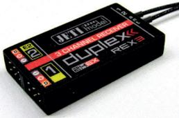
Alle 2.4EX Empfänger sind standardmäßig telemetriefähig. Ab dem Empfänger R9EX (und aufwärts) bieten sie zusätzlich die Möglichkeit, z. B. einen RSAT bzw. REX3 Empfänger als zweites Empfangsteil anzuschließen.
