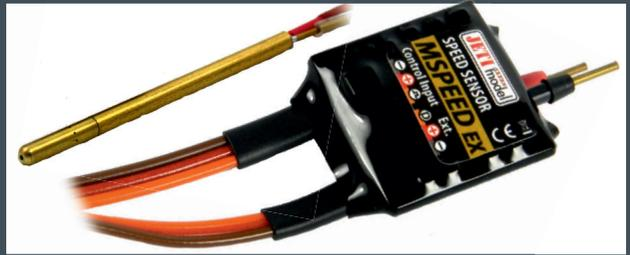
Modellgeschwindigkeit. MSPEED besteht aus einem Pitotrohr mit statischer Druckmessstelle und einem Sensor des Relativdruckes, der mit der statischen Druckmessstelle des Pitotrohres durch Silikonschläuche verbunden ist. Mit Hilfe des drahtlosen DUPLEX-Systems werden die gemessenen Informationen vom Sensor MSPEED in Realzeit zur JETIBOX übertragen, deren Anzeige den Anwender über die aktuelle Geschwindigkeit und die Abweichungen von den eingestellten Größen informiert.
