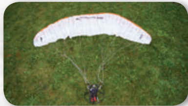
Den RC-Gleitschirm hufeisenförmig auslegen.
