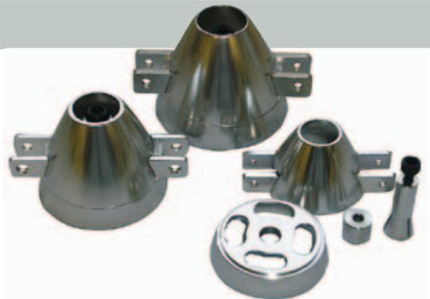
In schlanken Segler- oder Hotlinerrümpfen reichen seitlich Luftthutzen oft nicht aus, da der Kühlluftstrom damit nicht durch den Motor geleitet wird. So genannte Turbo-Spinner – hier gezeigt von Staufenbiel – leiten über ein Lüftungsloch in der Spitze bei Verwendung eines aufgebohrten Motorspans die Kühlluft direkt durch den Motor und sorgen damit für eine optimale Kühlung.
