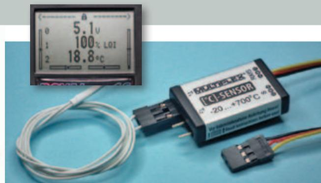
Der Messbereich des M-Link Telemetriesensors von Multiplex reicht von -25 bis +200°C. Die Daten werden direkt auf dem Senderdisplay angezeigt. Maximal-/Durchschnitts-/Minimalwerte werden in den Multiplex-Sensoren auch gespeichert und sind nach der Landung mit dem Programmiergerät Multimater auslesbar. Selbst mit nicht-telemetriefähigen-Anlagen sind die Sensoren so – mit Einschränkungen – nutzbar. Einen ausführlichen Bericht finden Sie in der FMT 08.2010.
