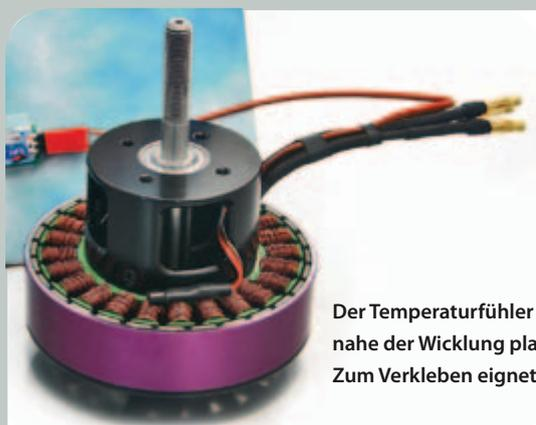
Der Temperaturfühler des Sensors sollte an oder nahe der Wicklung platziert werden. Zum Verkleben eignet sich UHU Endfest 300.
