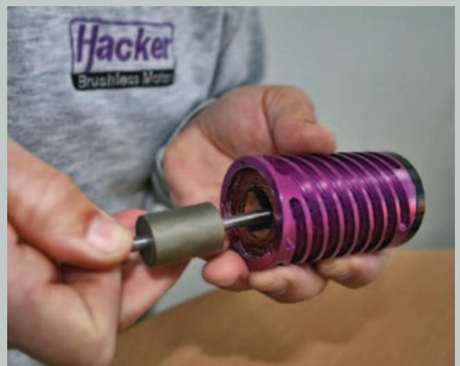
Ein zweipoliger Magnet (Rotor), hier als Blockmagnet, wird in den Stator eines Innenläufers gesetzt.
