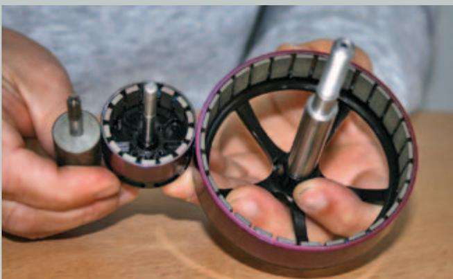
Die Magnete eines zweipoligen Innenläufers, mittig die eines 14-poligen und rechts eines 28-poligen Außenläufers.
