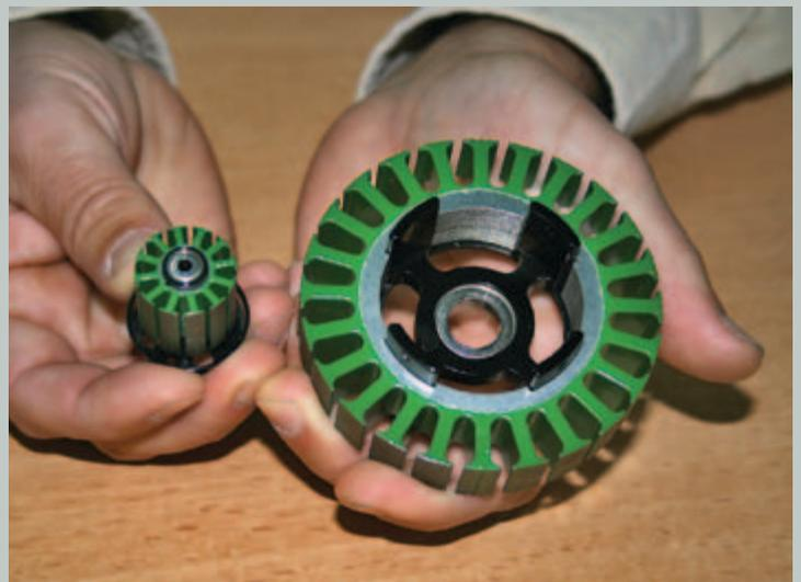
Ein A20-Stator mit 12 Nuten im Vergleich mit einem Q80-Stator mit 24 Nuten.
